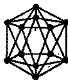
Рис. 3.17. Структура кристаллического бора.
