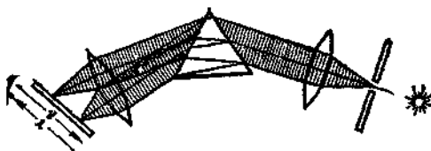
Рис. 1.1. Схема действия спектрографа.
